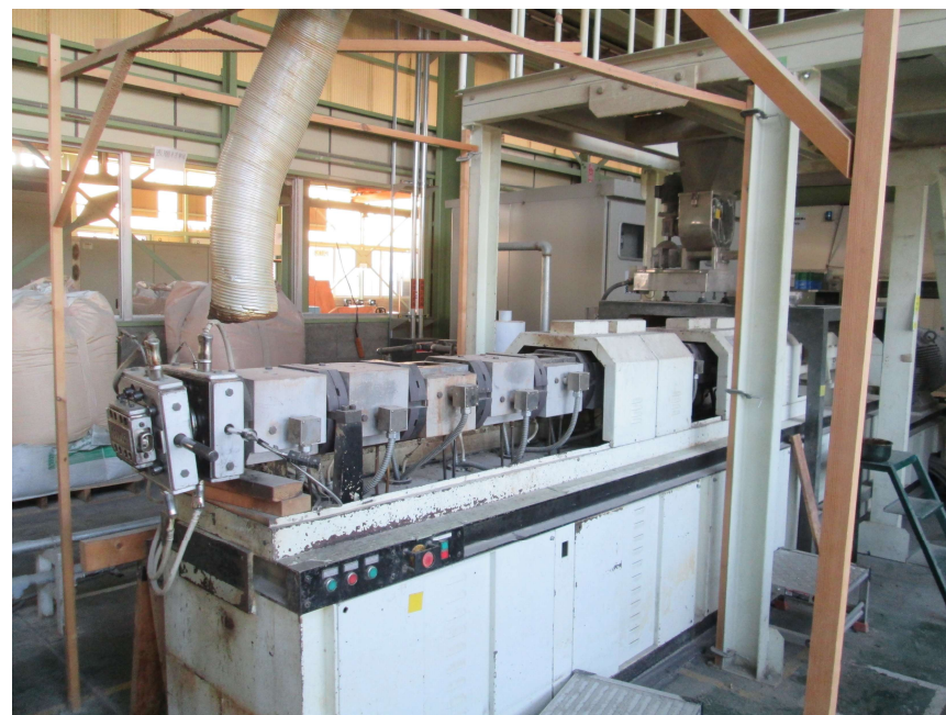
2軸押出造粒機 スクリュ径 70mm
