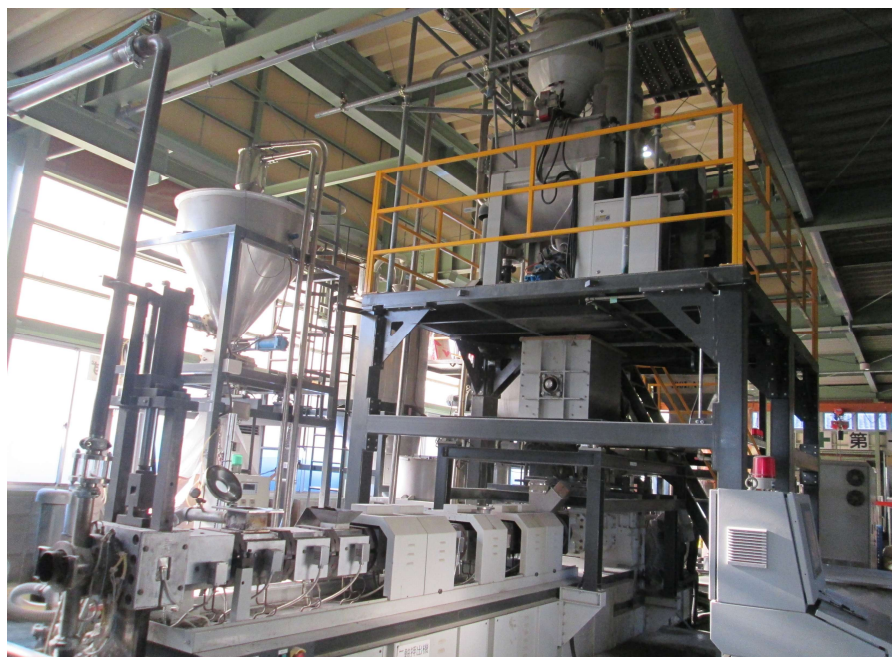
2軸押出造粒機 スクリュ径 80mm
